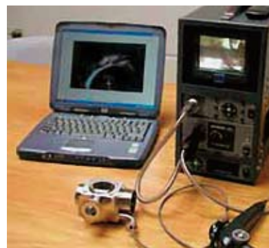
对所有用在洁净领域隔膜阀的阀体内表面焊缝进行内窥缝测试
