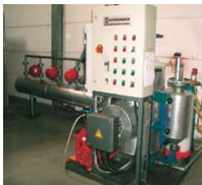
对隔膜片，执行器和阀体在 320°C 饱和蒸汽环境下进行循环周期测试。
